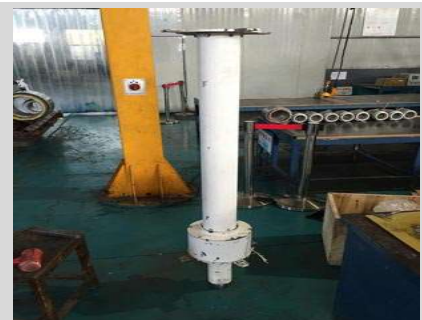
1.5KW 永磁风力发电机 PM motor for wind generator
